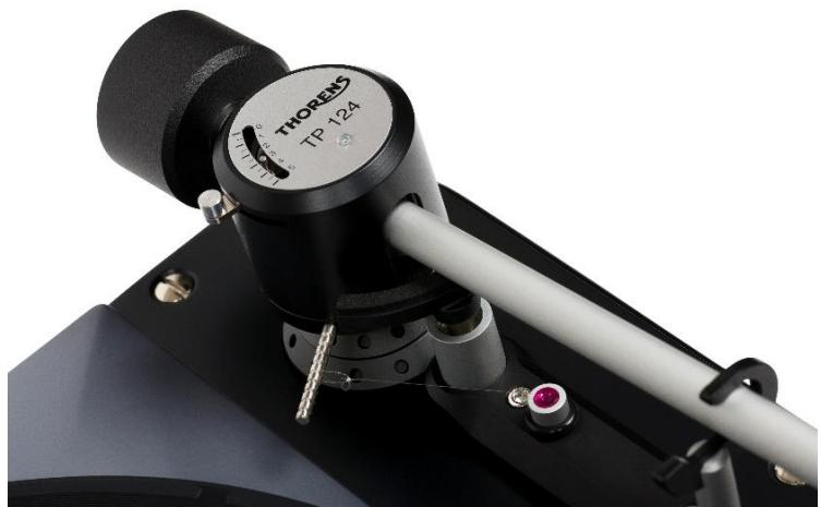
TP 124 は、スプリングを用いて針圧の加圧を行うダイナミック・バランス型トーンアームです。カウンターウェイトはゼロバランスを取るために使用されます。
