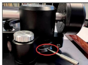
Fig. 14 ツールを使ってアームの高さを調整
