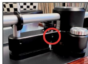
Fig. 15 リフターの高さ調整
