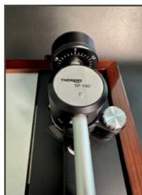
Fig. 8 ベアリング・ブロック、針圧の目盛りとアンチスケーティング調整用のカウンターウェイト
